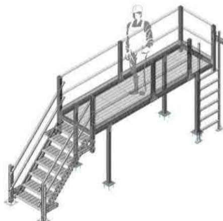
4.7 pav. Principinė aptarnavimo aikštelės schema su aptvėrimais, lipynėmis
